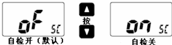
自检后出现下面的显示，需要检查机器排除故障后才能正常工作。
